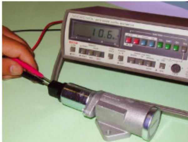
Y por último, verifica con el óhmetro que el embobinado de la válvula IAC no esté aterrizado con la carcasa, en caso de que la válvula esté aterrizada reemplázala.
