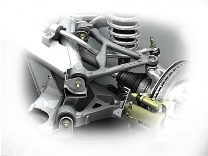
La evolución de estos sistemas de suspensión de paralelogramo deformable ha llegado hasta las actuales suspensiones llamadas multibrazo o multilink.
