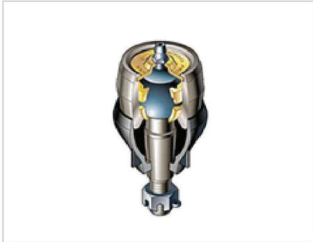
Su sustitución debe realizarse si existe en estas algún daño como por ejemplo, si esta deformada a causa de algún golpe, o cuando existen holguras (figura inferior).
